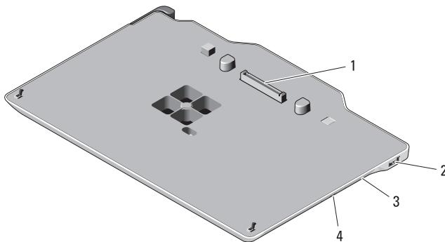
1 conector de acoplamento
